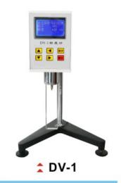
DV-1數字式旋轉粘度計由程控電機依據程序給定的轉速,通過扭矩傳感器帶動轉 子程速旋轉,當轉子在液體中受到粘滯阻力的扭力與扭矩傳感器抗衡力平衡時,經微 處理器處理顯示的讀數則是該液體的粘度。
